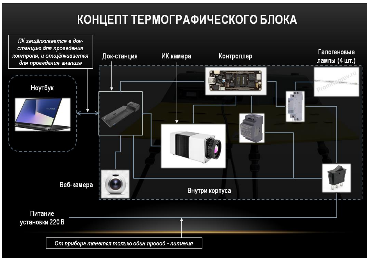
Рисунок 4 – Концепт технического решения мобильной системы НК
