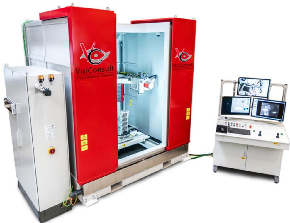
Рисунок 10 – Система НК рентгеновским методом закрытого типа
