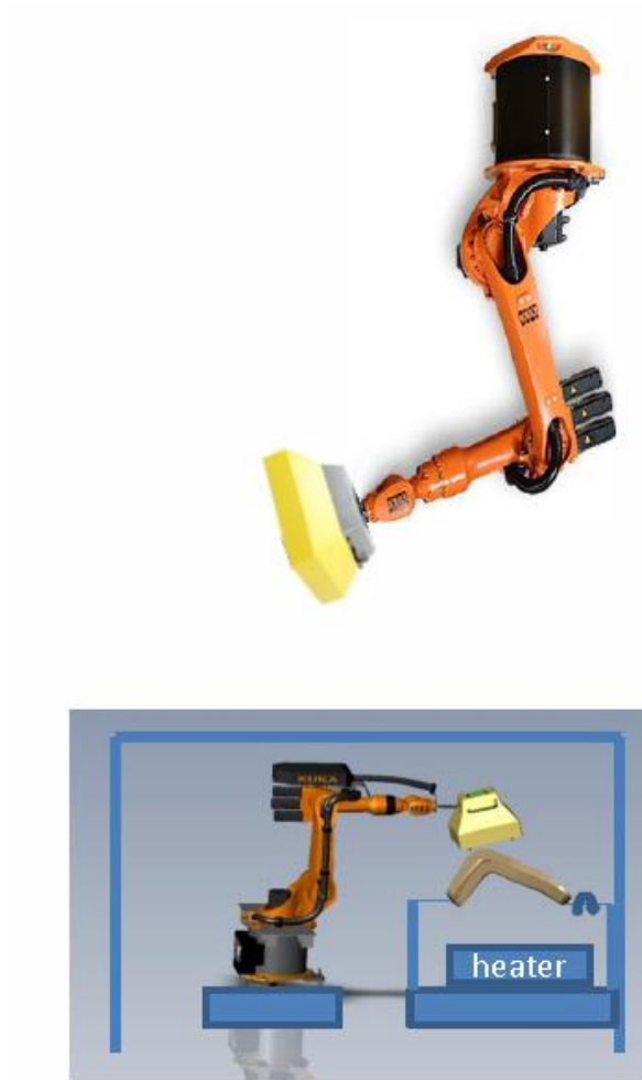
Рисунок 13 – Роботизированная система НК методом активной термографии
