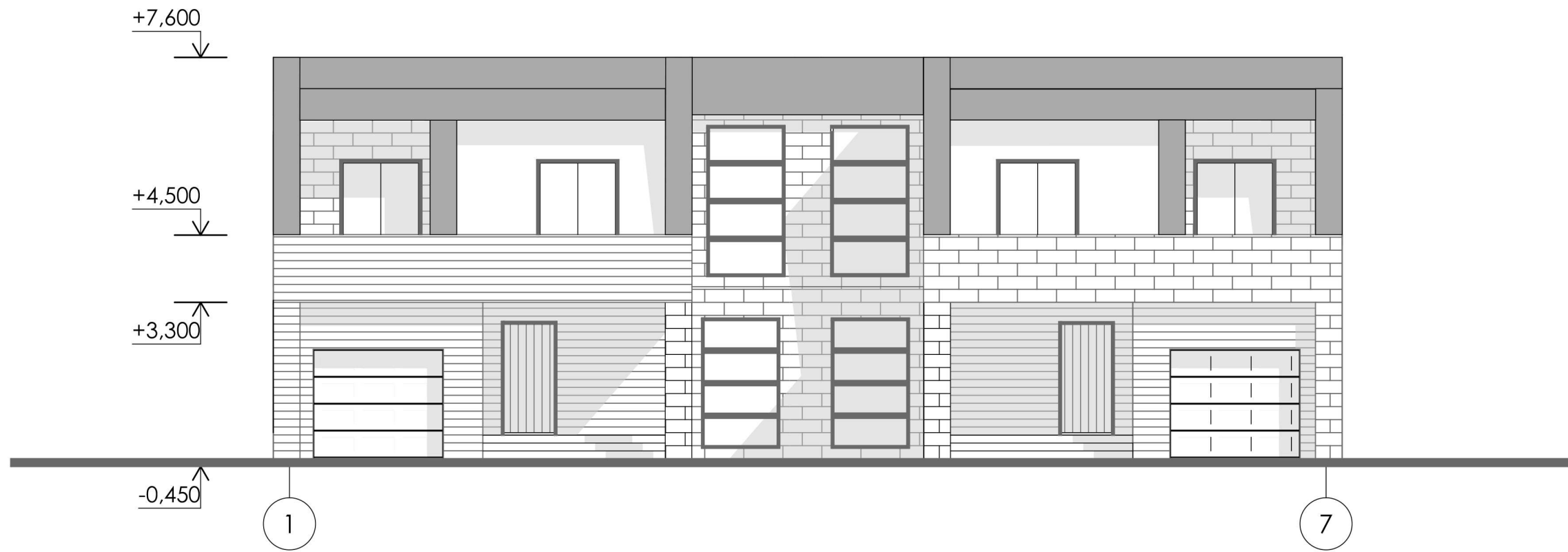
ФАСАД В ОСЯХ 1-7 (М 1:100)
