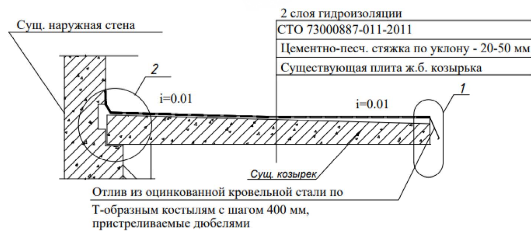
Узел (козырька над запасным выходом) 1
