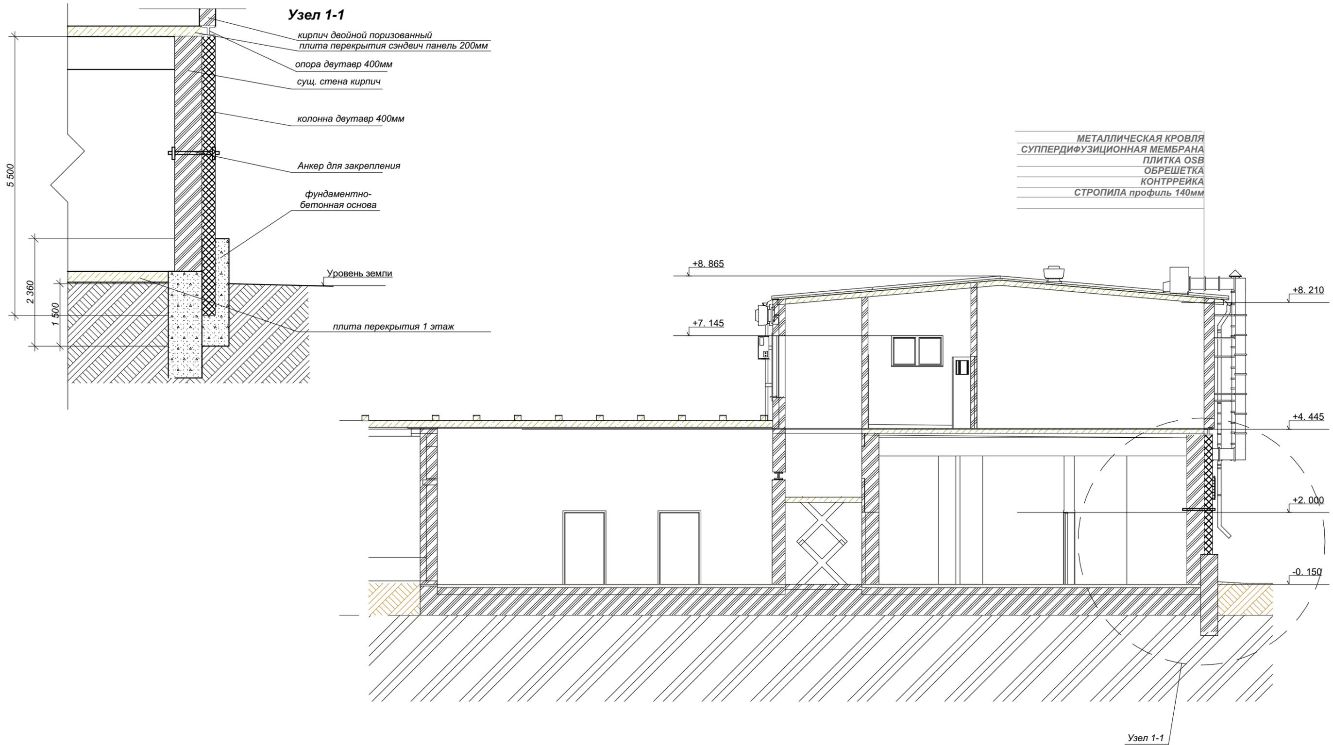
За относительную отметку 0.000 принят чистый пол 1-го этажа, что соответствует отметки схемы генерального плана.
